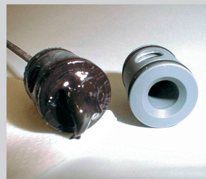
Un ugello contaminato con inchiostro, sia per l'uso di un errato elemento di filtro, sia per scarsa manutenzione. Foto Technotrans.
