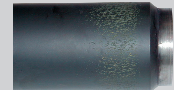
Rulli danneggiati a causa di regolazioni non uniformi che hanno aumentato notevolmente la temperatura di funzionamento. Foto Böttcher.
