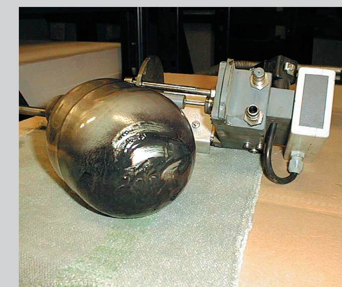
L'accumulo di sporco sul galleggiante dello stabilizzatore dell'alcol ne fa aumentare il peso e può modificare il contenuto di alcol nella soluzione di bagnatura. Foto Technotrans.
