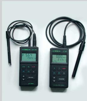
Les outils de contrôle de la solution de mouillage comprennent les conductimètres numériques, les pHmètres et les thermomètres (les outils numériques sont plus précis et plus faciles à calibrer), ainsi qu'un hydromètre pour mesurer le pourcentage d'alcool isopropylique, et enfin, un appareil de mesure de la dureté de l'eau. Photo Sun Chemical.
