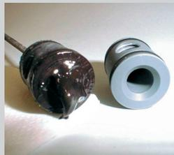
Buse d'injecteur contaminée par l'encre suite à l'utilisation d'un filtre inadapté ou à un défaut de maintenance. Photo Technotrans.
