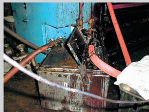
Surcharge d'un réservoir intermédiaire mal entretenu. Photo Technotrans.
