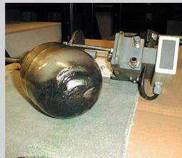
Les salissures accumulées sur le flotteur de stabilisation d'alcool augmentent son poids et peuvent modifier la teneur en alcool de la solution de mouillage. Photo Technotrans.
