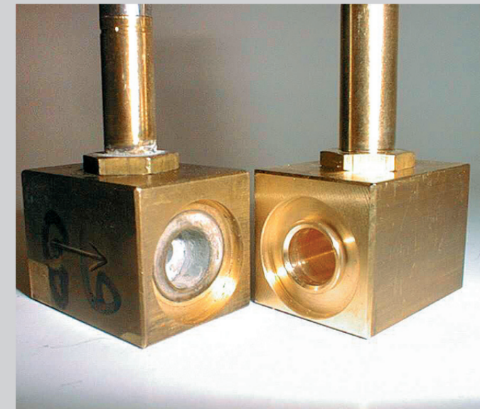
Corrosión de partes mecánicas al utilizar un aditivo incorrecto o agresivo o alcohol de baja calidad. Foto : Technotrans.
