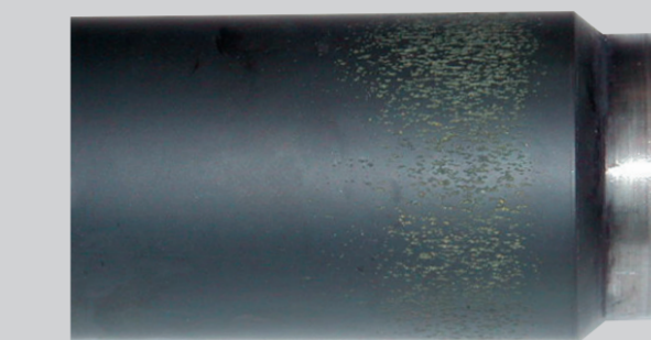
Rodillo dañado debido a un ajuste no uniforme que hay hecho aumentar notablemente la temperatura de trabajo. Foto : Böttcher.
