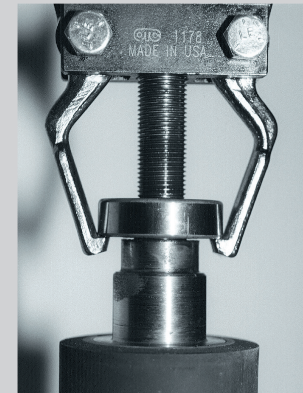
Utilizar siempre los utensilios adecuados para asegurar una colocación ajustada y recta de los cojinetes. Foto : Böttcher.
