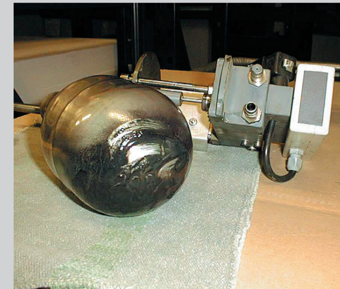
La acumulación de partículas en el flotador que estabiliza la adición de alcohol puede generar una variación en el contenido de alcohol y en la solución de mojado. Foto : Technotrans.
