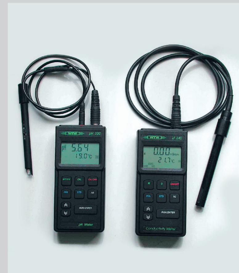
El sistema de control de la solución de mojado incluye un conductímetro digital, un pHmetro y un termómetro con sensor (los dispositivos digitales son más exactos y fáciles de calibrar), un densímetro para comprobar el porcentaje de alcohol y un comprobador de la dureza del agua. Foto : Sun Chemical.
