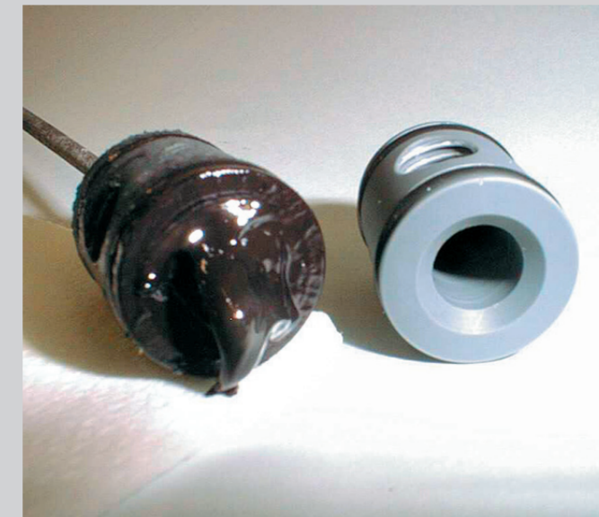
Boquilla contaminada con tinta al utilizar un filtro no adecuado o haber un mantenimiento pobre. Foto : Technotrans.
