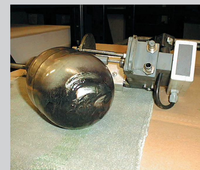
Schmutzablagerungen auf dem Alkohol - konstanthalter erhöhen dessen Gewicht und können den Alkoholgehalt im Feuchtmittel erhöhen. Foto Technotrans.
