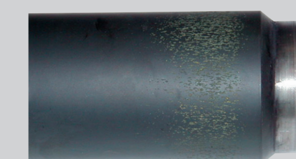
Beschädigung einer Walze durch ungleichmäßige Einstellung. Foto Böttcher.
