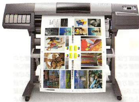
中間インキジェットブルーフィング装置 写真:コダックポリクロームグラフィクス
