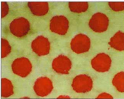
同一の条件下(刷版、プリプレス、紙、インキ)で印刷した網点を拡大したものです。品質改善はブランケット表面の変更により実現しました。 注:紙の地色の差は照明角度の違いによります。 出典: MacDermid
