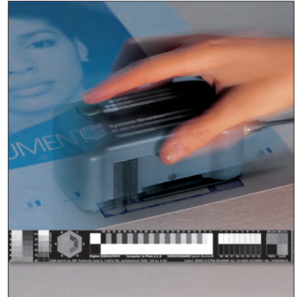
带有数字印版梯尺的印版读测量仪。同样网点测量仪经常用于测量印版（例如，X-rite ccDOT、Techkon DMS）。照片：布鲁纳尔系统
