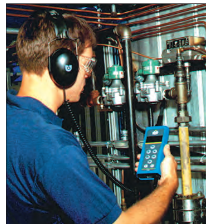
Цифровые ультразвуковые сканеры выявляют утечки сжатого воздуха и оценивают состояние подшипников
