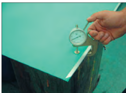
Пружинный измерительный инструмент измеряет толщину офсетного полотна вне машины.
