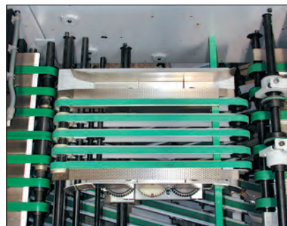
Регулярно проверяйте ленты на наличие износа, разрывов и правильность натяжения. Слишком слабое натяжение уменьшает передачу энергии, слишком сильное может привести к повреждению приводных двигателей Фото Muller Martini
