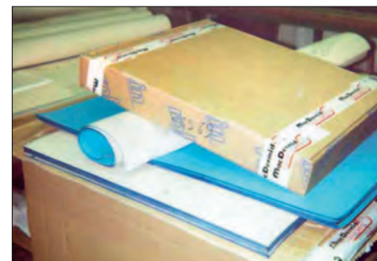
Неправильно установленные офсетные полотна повреждаются. Правильное расположение см. на с. 17 (часть 1).
