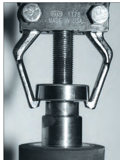
Всегда используйте подходящие инструменты для оптимальной посадки подшипника. Фото Boettcher
