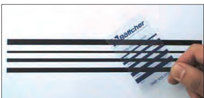
Полоса контакта должна проходить перпендикулярно оси печатной машины, проверьте это с помощью карты с заранее отпечатанными полосами для настройки валиков.
