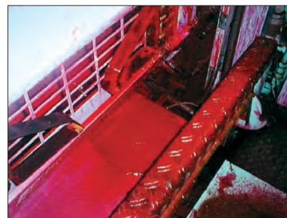
Грязная планка для защиты пальцев с неправильными зазорами: капающая краска оставляет следы и ведёт к обрыву полотна.
