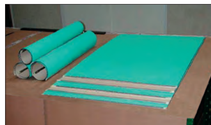
Офсетные полотна должны храниться плашмя, чтобы заранее не загибались против направления движения при печати, что затрудняет их установку.
