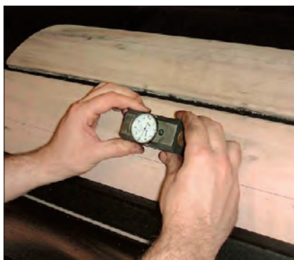
Используйте прибор Elcometer для измерения высоты офсетного полотна на цилиндре.
