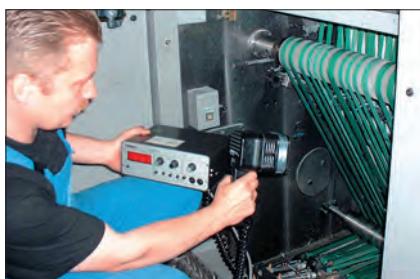
Стробоскоп помогает распознавать проблемы по движущимся частям. Фото MAN Roland
