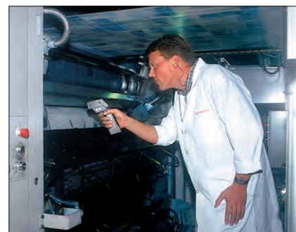
Регулярные инфракрасные измерения температуры показывают отклонения, являющиеся ранними признаками проблем
