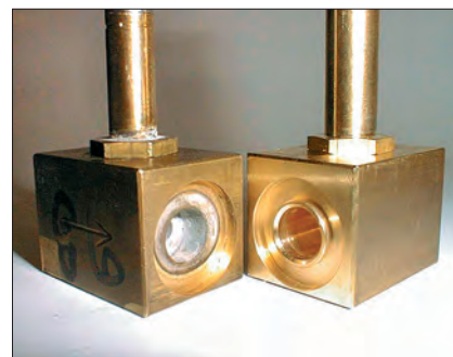
Коррозия механических частей в результате применения неподходящих, агрессивных добавок или спирта низкого качества.
