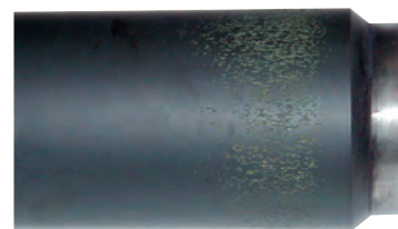
Повреждение валика вследствие неравномерной регулировки. Фото Boettcher
