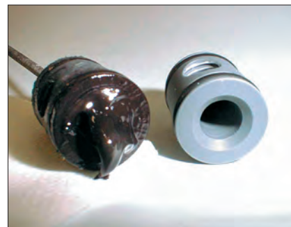
Загрязнённый краской сливной клапан из-за применения неподходящего фильтра или ненадлежащего ТО.
