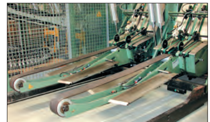
Очистите направляющие для несущих ремней на прижимном кронштейне, чтобы предотвратить повреждения натяжного ремня рулонов.
