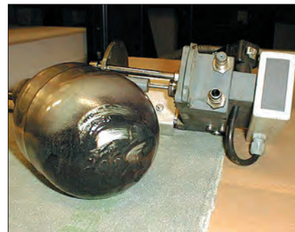
Отложения грязи на устройстве для поддержания постоянного содержания спирта увеличивают его вес и повышают содержание спирта в увлажняющем растворе.
