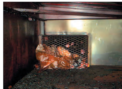
Если клочки бумаги на сетках фильтров не удаляются, они сгорают и распадаются на мелкие частицы, что приводит к сбоям в работе реле давления. Следствия — перерывы производства или конденсация.
