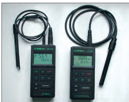
Инструменты контроля для систем увлажнения: электронный кондуктометр, pH-метр и проверочные термометры (цифровые инструменты точнее и легче калибруются), плотномер для определения содержания изопропилового спирта (ИПС) и тест жёсткости воды.
