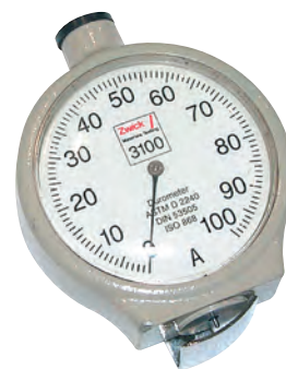
Используйте для измерения твёрдости только прибор, соответствующий нормам DIN EN ISO R868. Условия точного измерения: прибор держать вертикально, а показания считывать только через 3 с. Фото Boettcher
