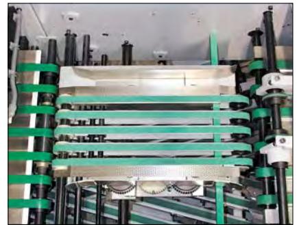
定期检查传送带的磨损、破裂和正确的张力。张力太小会降低能量传递，张力过大会损坏传送带。 照片：米勒·马天尼公司
