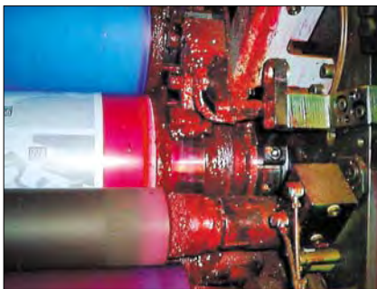
油墨堆积和纸粉是无计划停机和故障的主要原因。滚枕表面必须保持干净，并不断地润滑，以防止过早磨损。照片：曼罗兰公司
