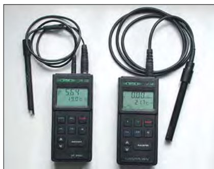
属于润湿系统用的监视仪器有：电子电导率测量仪、pH 值测量仪和温度测量仪（数字式仪器精确和易于校准），比重计用于测定异丙醇成份和测试水的硬度。
