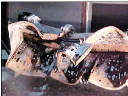
燃烧器维修不当和/或可燃混合气调节错误会损坏燃烧器。照片：MEGTEC 公司
