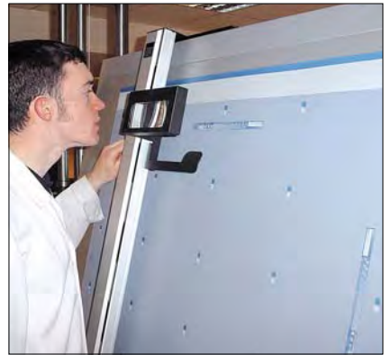
检查印版对减少停机时间起到关键作用。
