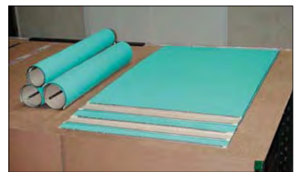
橡皮布应平置存放，防止朝压力方向变形，这会安装带来困难。重要的是，任何物体都不得放在橡皮布上，否则会造成橡皮布变形。
