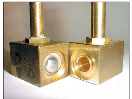
由于使用错误的、有侵蚀性的添加剂或劣质酒精，造成机械部件腐蚀。
