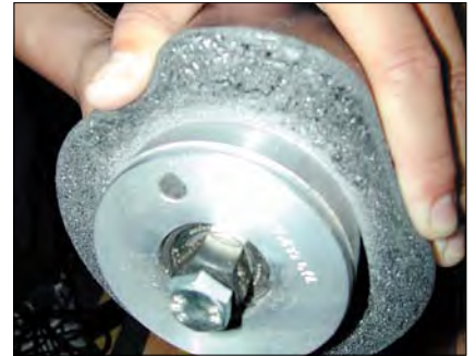
泡沫材料粘接辊良好的张力对于高效率粘接是绝对需要的。照片：MEGTEC 公司
