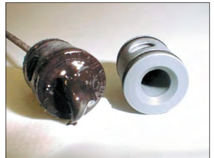
由于使用错误的过滤器或维修不当，造成油墨对流出阀门的污染。
