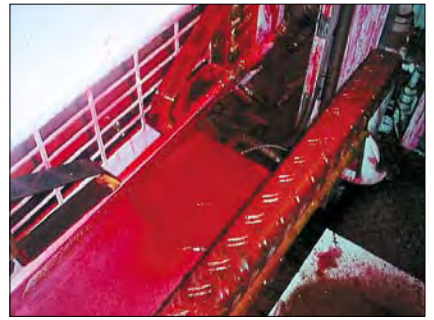
污垢的护指：滴下的油墨造成纸带脏迹，并导致纸带断裂。照片：曼罗兰公司
