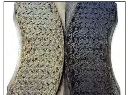
磨损的制动片造成纸带断裂和走纸的问题。当制动片达到推荐的最低的厚度时，应更换制动片。照片：MEGTEC 公司
