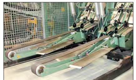
清洗压紧臂的承载传送带导板，防止纸卷张紧带损坏。照片：米勒·马天尼公司
