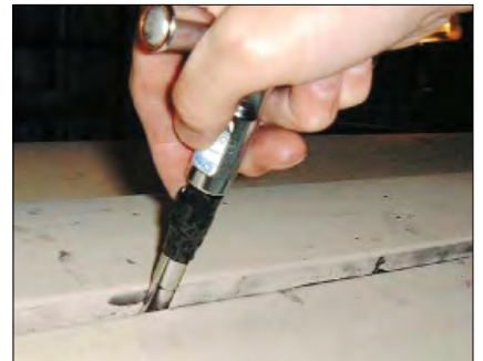
使用小的扭力扳手绷紧橡皮布。 照片：MacDermid 公司
