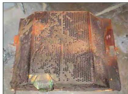
粘在风扇过滤器防护网上的纸张会燃烧并化成细微颗粒，这些颗粒物通过防护网进入风嘴，降低了压力，然后造成纸带蹭脏。
