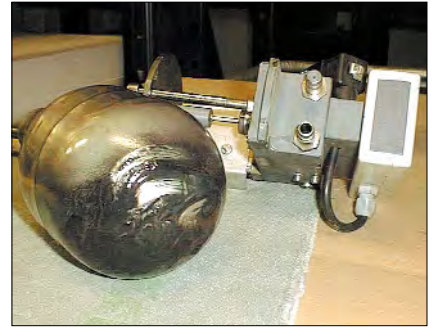
酒精稳定器上的污染沉积物增加其重量，并提高润版液中的酒精含量。
