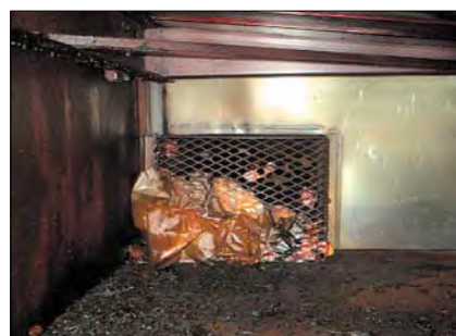
如果不清除滤网上的碎纸片，它会燃烧并化成细微颗粒，这将导致压力监控器的错误功能。同时也会中断生产或造成冷凝。
