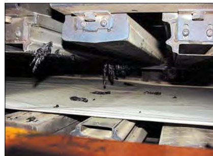
纸粉和油墨颗粒形成硬的堆积物，从风嘴的缝隙凸出，并导致纸带蹭脏和断裂。
