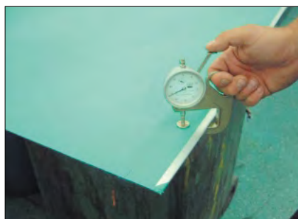
弹簧测量仪用于在机外测量橡皮布厚度。照片：MacDermid公司
