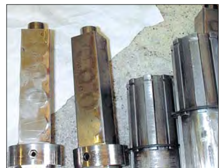
如果对支撑圆锥体和气压张紧轴不加以维护保养，这些部件会严重磨损，那就需要过早地更换。照片：MEGTEC 公司
