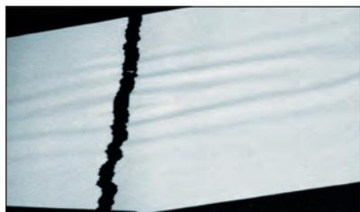
Фотография разрыва полотна на высокой скорости
