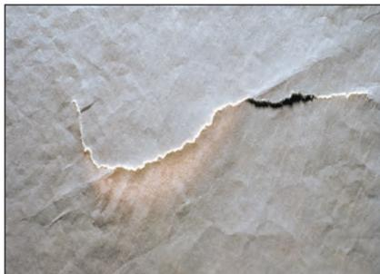
**Рис. H. Торцевые разрывы**
