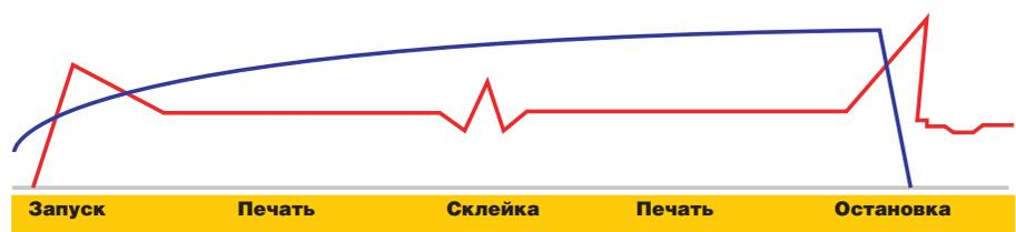
Оптимальные параметры натяжения в машине указываются изготовителем оборудования и варьируются в зависимости от модели. Обычно рекомендуемое натяжение в 5 раз ниже порогового значения, при котором происходит разрыв ленты. Настройки нужно постоянно регулировать, ориентируясь на характеристики бумаги, офсетного полотна, краски и увлажняющего раствора. Менять натяжение необходимо плавно и медленно.
