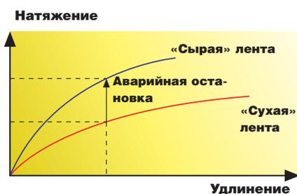
При отключении давления печати (натиска) в печатных секциях в случае аварийной остановки происходит быстрый переход с «сырого» натяжения на «сухое», приводящий к разрыву бумажной ленты. (Диаграмма IFRA: отчёт 1.18, с. 14, рис. 11)
