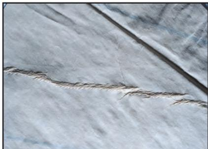
**Рис. G. Разрыв под действием внутреннего давления**
