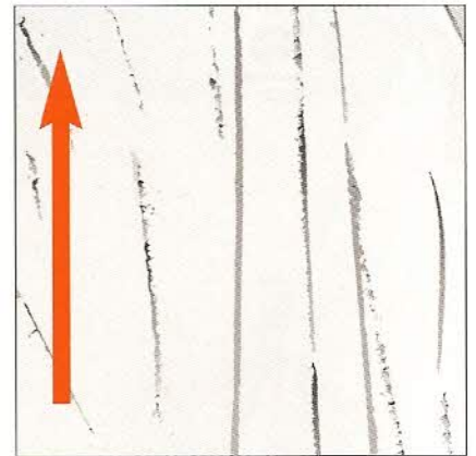
通常出摺子的走向与印刷机呈多角度。在机器方向中冷却辊造成出摺子是例外。
